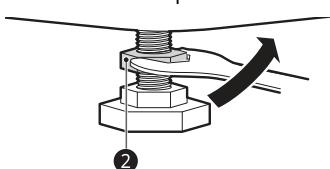
**4** Verificați dacă toate contrapiulițele din partea inferioară a aparatului sunt fixate corespunzător.
