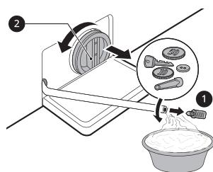
**4** După ce ați curățat filtrul pompei de evacuare, reintroduceți cu atenție filtrul și însurubați la loc cu atenție capacul pentru evacuare în sens orar pentru a evita deteriorarea filetului și eventuale scurgeri. Reintroduceți dopul înapoi în furtunul de evacuare și introduceți tubul în suportul aferent.
