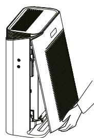
Поверніть кришку фільтра на місце та підключіть прилад до джерела живлення.
