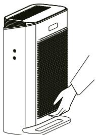
Retire la cubierta del filtro tirando del asa inferior
