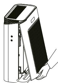
Vuelva a colocar la cubierta del filtro y conéctelo a la fuente de alimentación.
