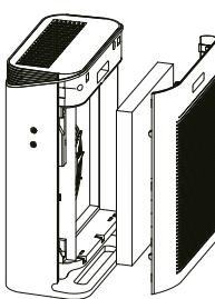
Așezați filtrul înapoi în purificator cu mânerul mic îndreptat spre exterior.
