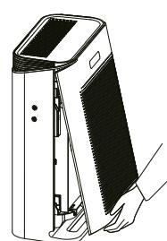
Vratite pokrov filtra i spojite aparat na električnu energiju.
