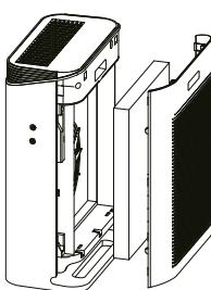
Coloque el filtro en el interior del purificador con su pequeña asa hacia afuera.
