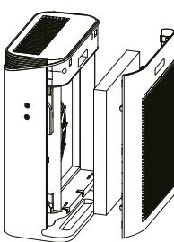
Помістіть фільтр назад в очищувач так, щоб його ліва ручка була спрямована назовні.
