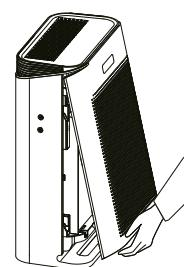
Helyezze vissza a szűrőfedelet és csatlakoztassa a készüléket az áramforráshoz.
