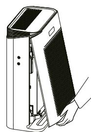
Vraťte víko filtru zpět na místo a zapojte přístroj do elektrické sítě.
