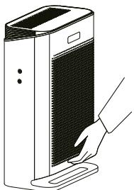
Entfernen Sie die Filterabdeckung, indem Sie am unteren Griff ziehen
