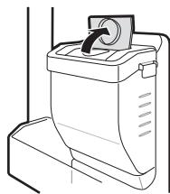
**2** Napunite rezervoar za vodu pijaćom vodom i zatvorite čep.
