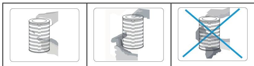
**Čišćenje početnog filtra:** Otvorite rešetku za ulaz zraka, izvadite filtrirajući element pa usisivačem opremljenim s četkastim nastavkom ili suhom četkom očistite prašinu na površini filtra.
