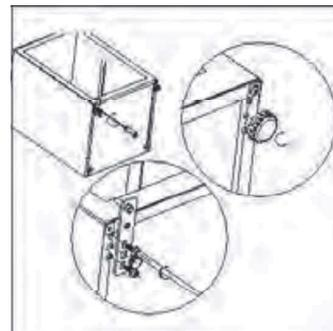
7. Volte a colocar a porta. Verifique se está bem alinhada horizontal e verticalmente para que as juntas fiquem devidamente seladas antes de apertar a dobradiça superior.
