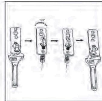
6. Volte e ajuste o suporte, configurando a dobradiça inferior.
