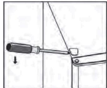
4. Retirar o núcleo da tampa do lado esquerdo para o lado direito. Em seguida, levante a porta superior e coloque-o sobre uma superfície macia para evitar arranhões.
