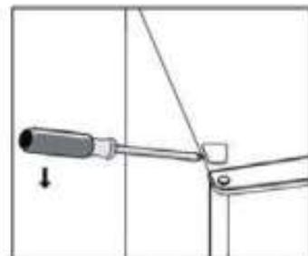
4. Mueva la cubierta del núcleo del lado izquierdo al lado derecho. Y luego levante la puerta superior y colóquela sobre una superficie acolchada para evitar que se raye.
