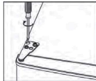
10. Coloque a tampa da dobradiça e a tampa de rosca de volta.
