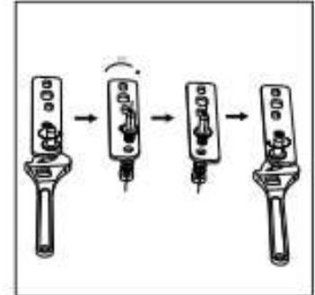
6. Vuelva a colocar el soporte que encaja en el pasador de la bisagra inferior. Reemplace ambos pies ajustables.
