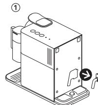
Vzemite cev za odstranjevanje vodnega kamna na zadnji strani naprave in priključite cev za odstranjevanje vodnega kamna na parni konektor naprave.
