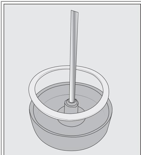
Po potrebi možete da skinete spojni deo i zaptivni prsten iz poklopca posude za mleko. Kada ste skinuli cev od plemenitog čelika, spojni deo može malo da se izgura sa unutrašnje strane poklopca. Pojedinačne delove operite u mašini za pranje sudova.
