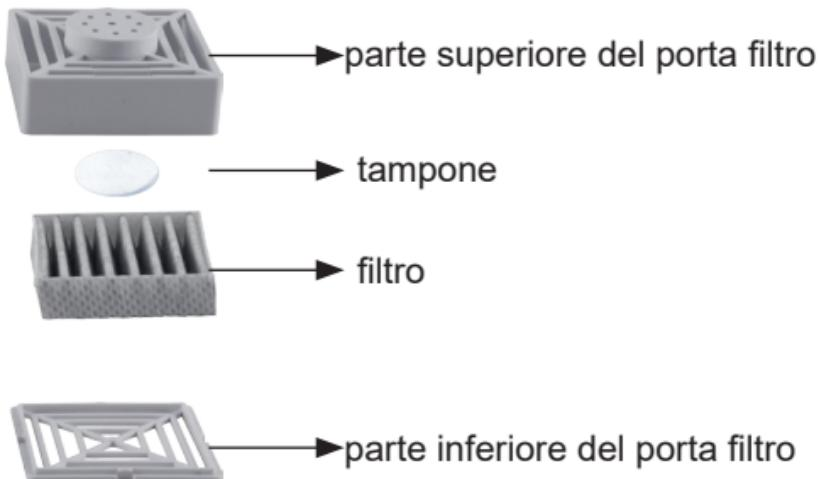
Richiudere il porta filtro, riposizionarlo nel prodotto e chiudere il prodotto agganciando il corpo inferiore al corpo principale. Fissarlo ruotandolo leggermente in senso orario.
