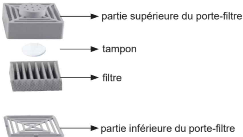
Fermer le porte-filtre, le repositionner dans le produit et fermer le produit en accrochant le corps inférieur au corps principal. Le fixer en le tournant légèrement dans le sens des aiguilles d'une montre.
