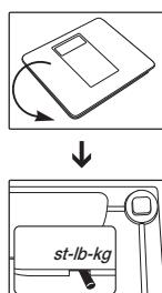
DE Waage ist umschaltbar.
