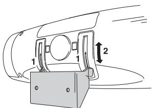
Блок управления может поворачиваться на кронштейне, благодаря чему можно регулировать наклон. Фиксация препятствует снятию блока управления с кронштейна в наклоненном положении.
