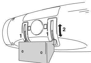
Das Bedienteil kann auf dem Wandhalter geschwenkt und die Neigung damit angepasst werden. Eine Arretierung verhindert, dass sich im geschwenkten Zustand das Bedienteil vom Wandhalter abnehmen lässt.
