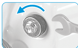
Ključem otpustite 4 transportna vijka
