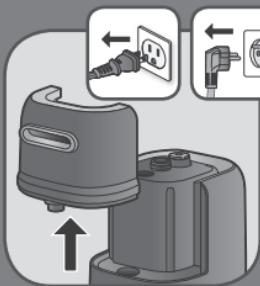
**BS** Isključite aparat iz strujnog napajanja, a zatim izvadite spremnik za vodu.
