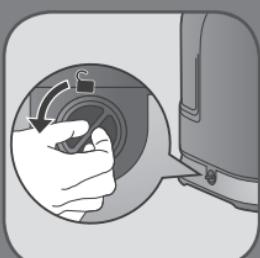
**EL** Τοποθετήστε τη συσκευή πάνω από το νεροχύτη και ξεβιδώστε το πώμα αφαλάτωσης, γυρνώντας το αριστερά.
