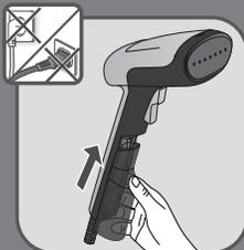
**RO** Puneți la loc rezervorul de apă prin glisare până când este complet introdus. Asigurați-vă că rezervorul de apă este complet introdus în locașul său.
