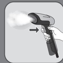
**RU** Подождите не менее 15 секунд перед нажатием на кнопку подачи пара. Дайте устройству поработать, пока резервуар для воды полностью не опустеет.
