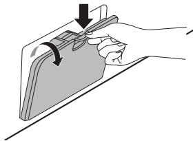
**3** Prvo uklonite čep sa odvodne cevi **1**, a zatim ispustite vodu. Zatim polako odvrnute filter odvodne pumpe **2** da ispustite preostalu vodu, a zatim nastavite da uklanjate ostatke ili objekte iz filtera.
