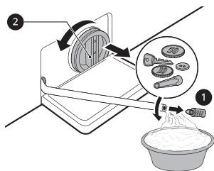
**4** Nakon čišćenja filtera odvodne pumpe, pažljivo ponovo umetnite filter i zavrnete čep na odvodnu cev u pravcu kazaljki na satu da izbegnete preplitanje niti i curenje. Ponovo umetnite čep na odvodnu cev i postavite cev u držač.
