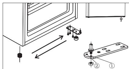
4. Postavite vrata u novi položaj, pri čemu prekontrolišite da li klin odnosno čep šarnira ulazi u otvor na donjem delu okvira. Ponovno namestite poklopac montirajući centralni deo gornjeg šarnира u otvor na vrhu vrata, i pričvrstite ga pomoću dva šrafa. Premestite i dva šrafa na drugu stranu.
