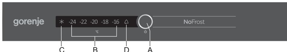
**A Taster za uključenje i isključenje aparata te podešavanje temperature i dodatnih funkcija**
