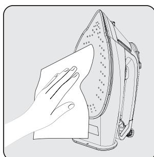
Sve ostatke izvan uređaja i na ploči (9) obrišite vlažnom krpom i, ako je potrebno, lakin, neabrazivnim tečnim sredstvom za čišćenje.
