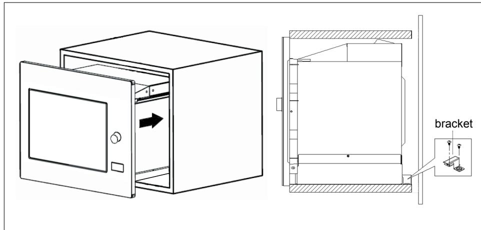
5. Abra la puerta, fije el horno en el gabinete con el tornillo B, en el orificio de instalación. A continuación, fije la cubierta de plástico del Trim-kit en el orificio de instalación.
