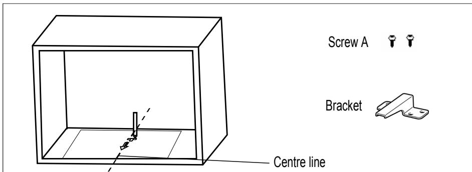
3. Retire la plantilla del gabinete inferior y fije el soporte con el tornillo A.
