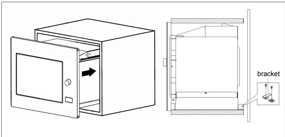
5. Abra a porta, coloque o forno no armário com o parafuso B, no orificio de instalagao. Em seguida, fixam a tampa de plástico no orificio de instalagao.
