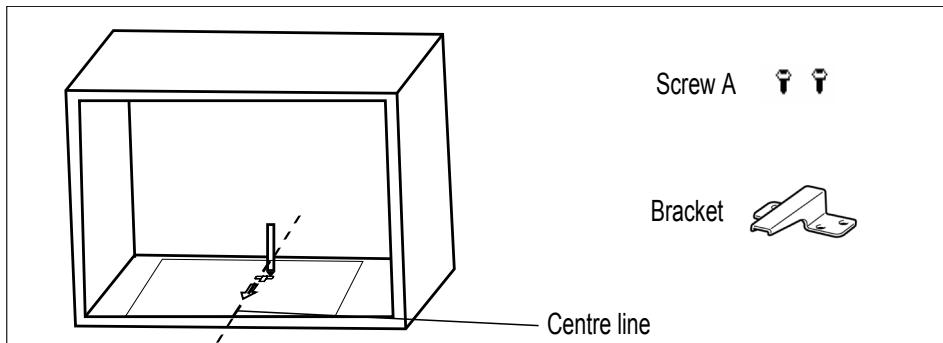
3. Odstranite uzorak i pričvrstite nosač šrafom A
