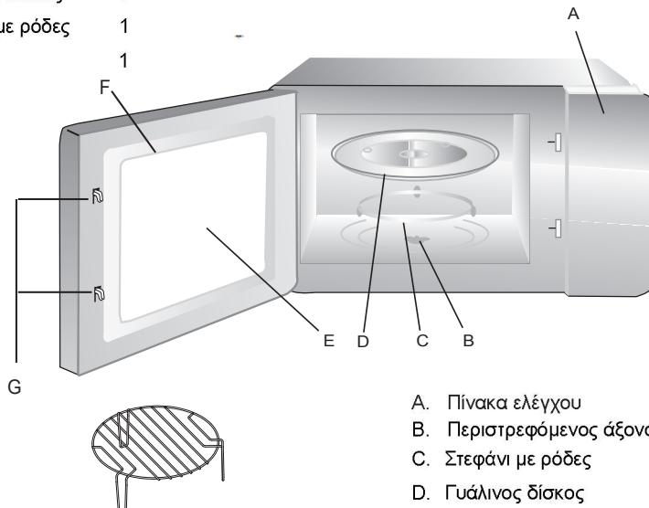
Σχάρα γκριλ (Χρησιμοποιείται μόνο στη λειτουργία γκριλ και τοποθετείται στο νυάλινο δίσκο)
