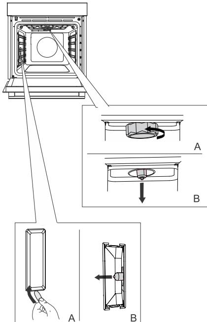
**1** Otpustite i uklonite poklopac (u smeru suprotnom od kretanja kazaljki na satu). Uklonite halogenu sijalicu.
