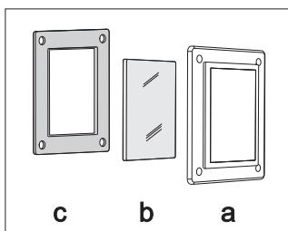
Na poklopcu je zaptivač kog ne smete odstraniti, niti smete dozvoliti da zaptivač odstupi od poklopca. Zaptivač treba pravilno da se priljubi uza stenu unutrašnje komore peći.
