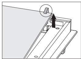
**1** Lagano podignite nosače na levoj i desnoj strani vrata (oznaka 1 na nosaču), a zatim ih lagano povucite od stakla (oznaka 2 na nosaču).
