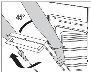
**3** Vrata lagano zatvarajte do ugla 45°(obzirom na zatvoren položaj vrata), a zatim ih podignite i izvucite.
