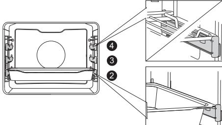
Kod teleskopskih vodilica na izvlačenje najpre izvučete par vodilica jednog nivoa, na njih stavite rešetku ili tepsiju za pečenje i rukom ih gurnete nazad do kraja u rernu.
