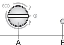
**A Dugme za uključenje i isključenje aparata, odnosno dugme za podešavanje temperature u aparatu;** tim dugmetom upravljate i funkcijom ECO kao i intenzivnim hlađenjem/zamrzavanjem.
