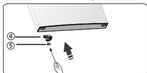
11. Premestite čepove otvora šrafa na srednjoj prekrivnoj ploči sa leve na desnu stranu (kao što to prikazuje donja slika).
