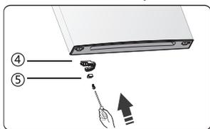
9. Koristeći imbus ključ (isporučen u plastičnoj kesici) i križni šrafciger olabavite šrafove i uklonite srednji desni šarnir. Nakon toga ponovno zatvorite vrata.
