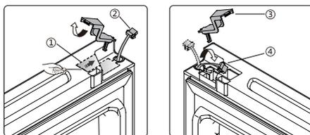
8. Otpustite šraf 3 i skinite deo br. 2 i deo br. 1. Montirajte rezervnu blokadu vrata 4 i levi graničnik 5 (priloženi su u plastičnoj kesici) na levu stranu pomoću vijka 3. Spremite deo br. 1 i deo br. 2 u blizinu aparata za buduće potrebe.
