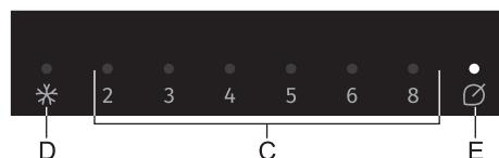
**Uključenje:** Eco funkciju uključite tako da taster **B** pritisnete toliko puta da zasvetli signalna lampica iznad simbola **E**. Tada aparat funkcioniše na optimalnim regulacijama.
