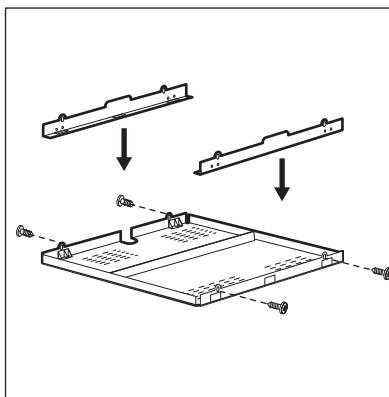
Po zamontowaniu kasy ochronnej (wyposażenie dodatkowe) nie ma konieczności montażu przegrody zabezpieczającej bezpośrednio pod płytą grzejną. Akcesoria ochronne mogą być niedostępne w niektórych krajach. Skontaktować się z serwisem.
