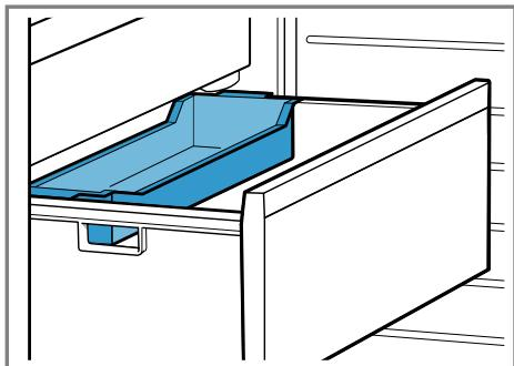
Ravnomerno rasporedite namirnice za zamrzavanje u posudi za zamrznuće namirnice i ostavite ih otpr. 10 do 12 sati da se zamrzavaju. Zatim upakujte u kesu za zamrzivač ili posudu za zamrzivač.
