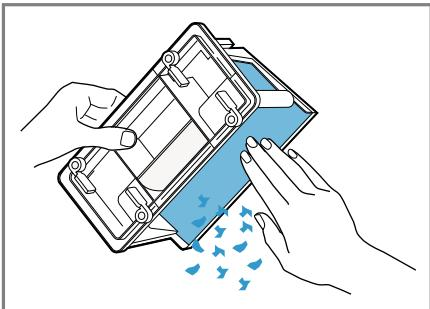
Uverite se da ste uklonili sve nečistoće sa zaptivke.
