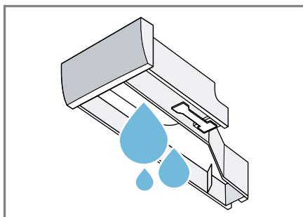
7. Jedinicu pumpe očistite vlažnom krpom.
