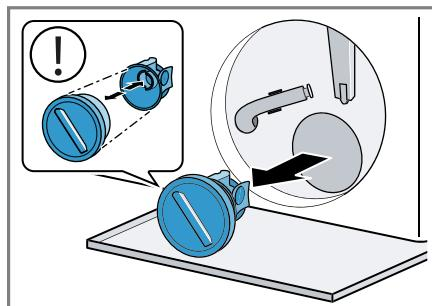
2. Očistite unutrašnjost, navoj poklopa pumpe i kućište pumpe.
