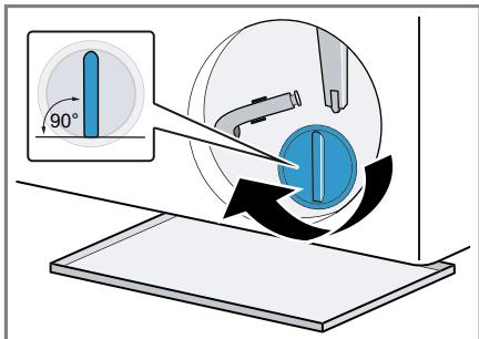
Ručka poklopca pumpe mora da stoji vertikalno.
