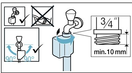
**Savet:** Povežite i spoljašnji filter za vodu (u zavisnosti od modela) između creva za dovod vode i slavine. Filter filtrira čestice prljavštine iz vode.
