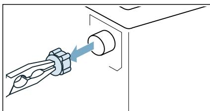
3. Malom četkom očistite filter.
