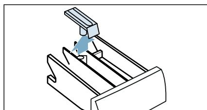
3. Očistite vodom i četkom posudu i umetak dispenzera za deterdžent i osušite. Takođe očistite i unutrašnjost kutije.
