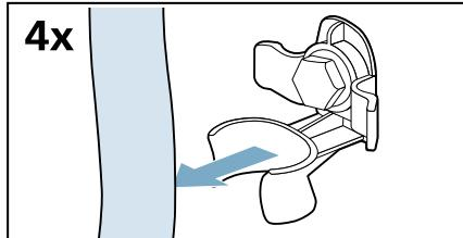
2. Odvrnite i uklonite sva četiri zavrtnja sa transportnog nosača.
