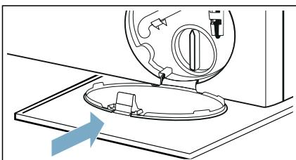
**Uputstvo:** Da biste sprečili isticanje neiskorišćenog deterdženta direktno u odvod prilikom sledećeg pranja: Sipajte pribl. 1 litar vode u Dispenser II i pokrenite program **Drain (Isušivanje)**.
