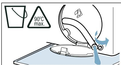
4. Pažljivo odvijte poklopac pumpe; ostatak vode može da iscuri. Očistite unutrašnjost, navoj poklopca pumpe i kućište pumpe. Kolo pumpe u pumpi za odvod vode treba da bude u mogućnosti da se okreće.
