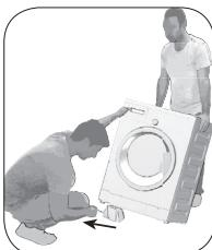
Nagnite stroj prema nazad da biste uklonili pojačanja pakiranja. Uklonite pojačanje pakiranja povlačenjem trake. Ovaj postupak nemojte raditi sami.
