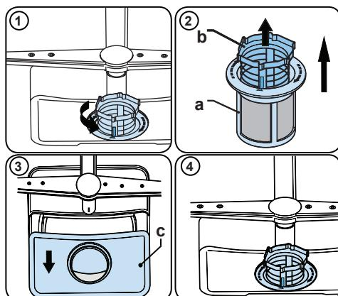
Da biste uklonili i očistili kombinaciju filtera, okrenite je u smeru suprotnom od kazaljke na satu i izvadite je podižeći prema gore (1). Izvucite grubi filter iz mikro filtera (2). Zatim izvucite i uklonite metalni filter (3). Isplaknite sa mnogo vode dok se ne očiste ostaci. Ponovo sklopite filtere. Zamenite uložak filtera, i okrenite ga u smeru kazaljki na satu (4).
