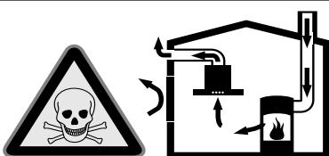
Vatrišta koja zavise od vazduha u prostoriji (npr. grejni uređaji na gas, ulje, drvo ili ugalj, protočni bojleri, kotlovi za zagrevanje vode) vazduh za sagorevanje crpe iz prostorije u koju su postavljeni i izduvne gasove izbacuju preko sistema za izduvne gasove (npr. kamoin) u spoljašnju sredinu.
