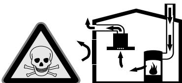
Vatrišta koja zavise od vazduha u prostoriji (npr. grejni uređaji na gas, ulje, drvo ili ugalj, protočni bojleri, kotlovi za zagrevanje vode) vazduh za sagorevanje crpe iz prostorije u koju su postavljeni i izduvne gasove izbacuju preko sistema za izduvne gasove (npr. kamoin) u spoljašnju sredinu.
