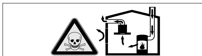
Kuhaliča, ki so odvisna od prostorskega zraka (npr. grelne naprave na plin, olje, les ali oglje, pretočni grelniki, bojlerji), jemljejo zrak za izgorevanje iz prostora postavitve in odvajajo dim prek sistema za odvajanje dima (npr. napa) na prosto.
