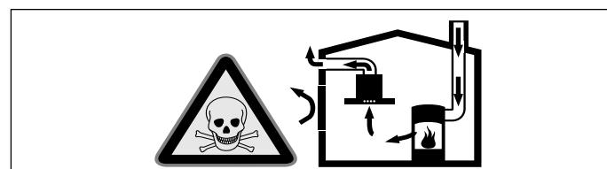
Vatrišta koja zavise od vazduha u prostoriji (npr. grejni uređaji na gas, ulje, drvo ili ugaj, protočni bojleri, kotlovi za zagrevanje vode) vazduh za sagorevanje crpe iz prostorije u koju su postavljeni i izduvne gasove izbacuju preko sistema za izduvne gasove (npr. kamoin) u spoljašnju sredinu.
