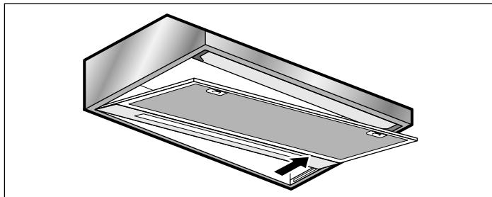
4. Uklonite žice i izvadite filter za mast od netkanog materijala.
