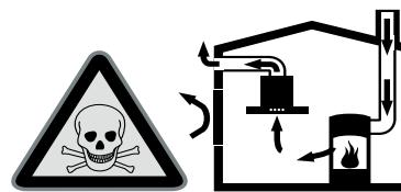
Kurišča, odvisna od zraka v prostoru (npr. grelne naprave na plin, olje, les ali premog, pretočni grelniki, bojlerji) črpajo zrak za izgorevanje iz prostora, v katerem so nameščeni, in odvajajo izpušne pline prek sistema za odvajanje plinov (npr. dimnika) na prosto.
