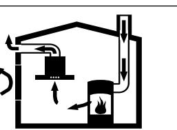
Grijala na plamen koja ovise o zraku iz prostorije (npr. plinska grijala, grijala na ulje ili ugljen, protočni grijaci vode, uređaji za pripremu tople vode) troše zrak za sagorijevanje iz prostorije u kojoj je postavljen uređaj i odvode dimne plinove kroz dimovodne uređaje (npr. dimnjak) na otvoreno.
