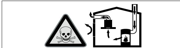
Vatrišta koja zavise od vazduha u prostoriji (npr. grejni uređaji na gas, ulje, drvo ili ugaj, protocni bojleri, kotlovi za zagrevanje vode) vazduh za sagorevanje crpe iz prostorije u koju su postavljeni i izdunve gasove izbacuju preko sistema za izdunve gasove (npr. kamoin) u spoljašnju sredinu.
